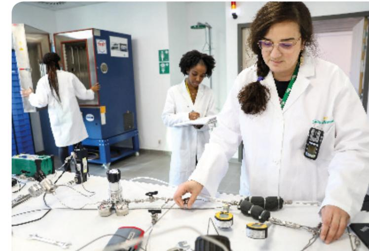
Test de matériel de détection du gaz en laboratoire
